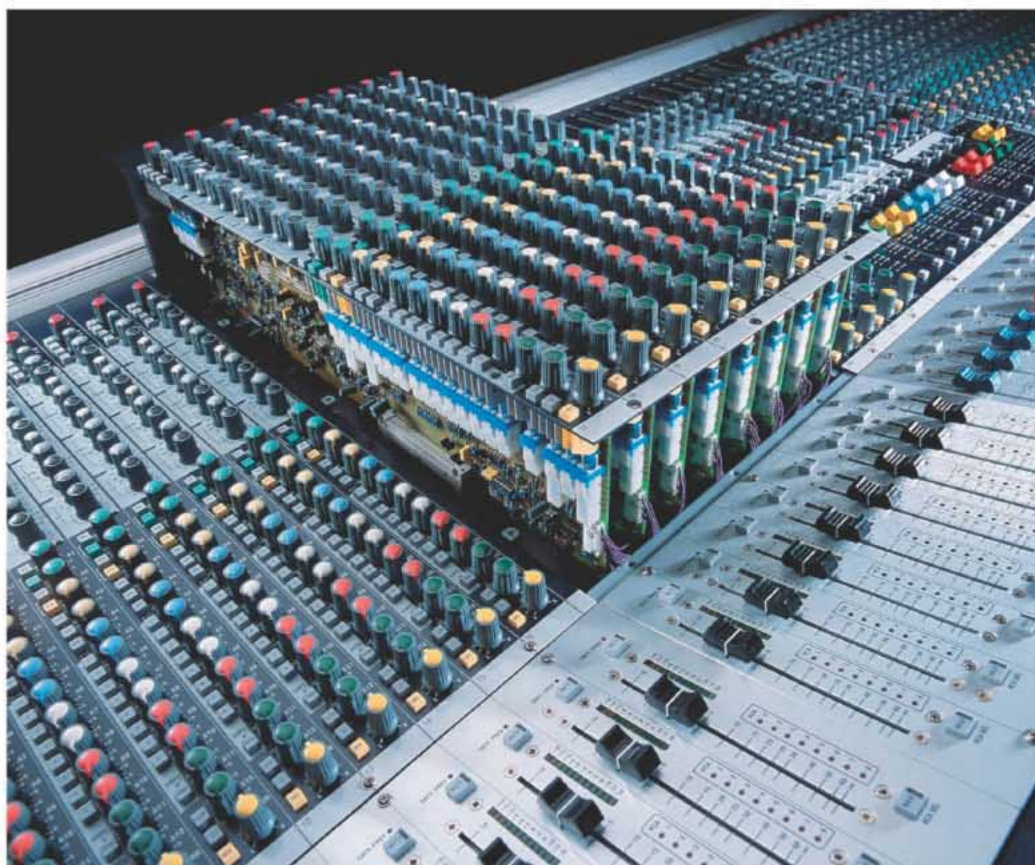
Budowa panelowa konsoly
