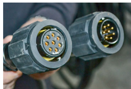
Zarówno gniazda jak i wtyki kabli głośnikowych mają złoczone piny.
