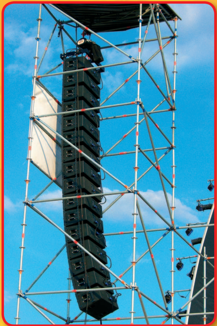
16 szt. VerTec 4888 na stronę w linii sceny za ekranami diodowymi.
